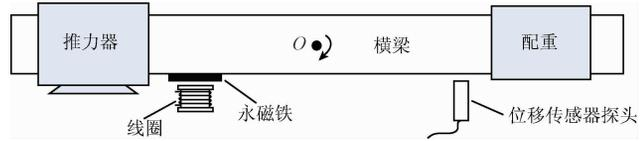
图 1 采用电磁力标定装置的扭摆横梁俯视图
