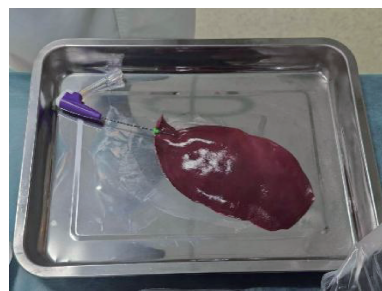
图9 离体猪肝微波消融实验
