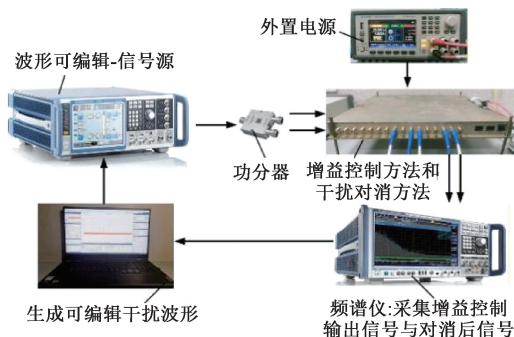
图 8 本文所提方法的增益控制与干扰对消实验场景
