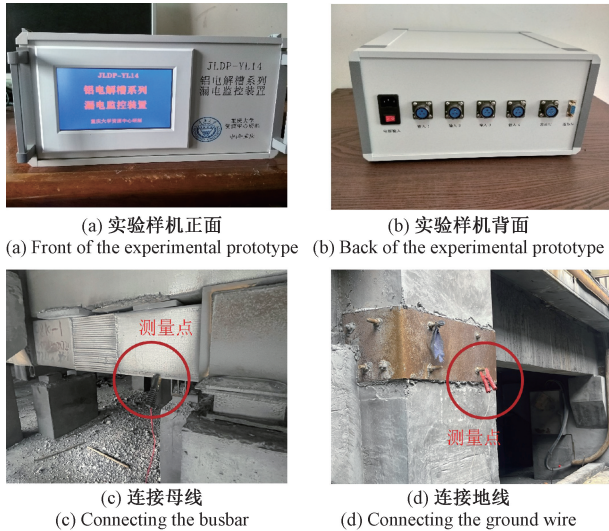
图5 铝电解系列漏电监控装置及现场实验
