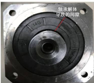
图 24 天线俯仰轴传动链减速器损坏图
