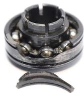
(b) 轴承外圈裂纹故障
