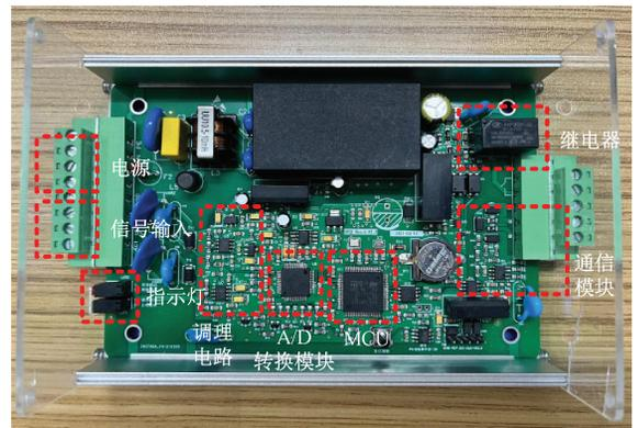
图 14 RCD 样机实物
