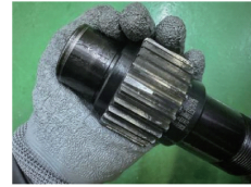
(b) 小齿轮50%断齿实物图
