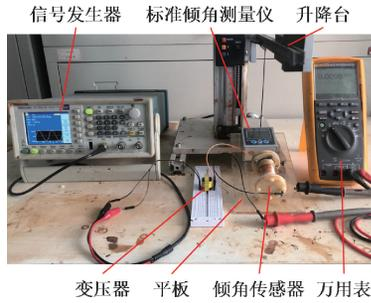
图 10 倾角测量实验装置
