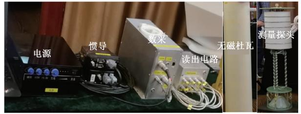
图 3 硬件系统实物图
