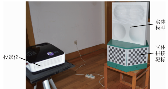
图8 实体模型的拼接试验现场
