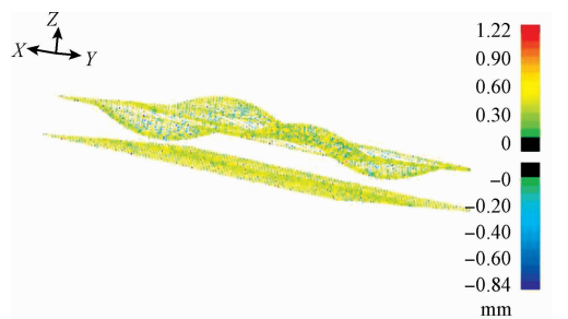
(b) 方法B的点云偏差分布 (b) Point cloud deviation distribution diagram for method B
