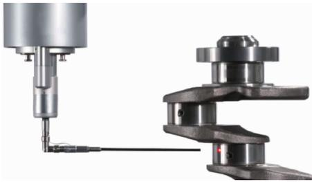
图9 HP-O 激光测头
