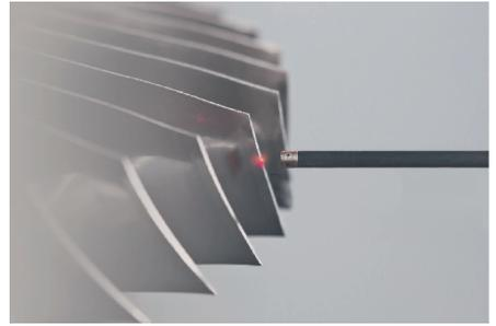
图 13 Leitz 非接触式四轴联动叶盘检测方案
