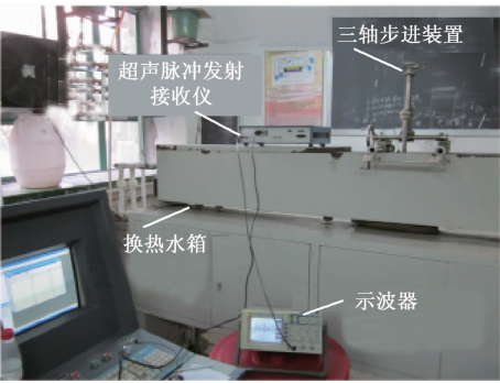
图 10 超声检测系统总体构成情况
