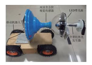
图 1 视觉检测、识别和重构的管道机器人<sup>[5]</sup> Fig. 1 Pipeline visual inspection robot
