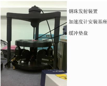
图 5 冲击激励校准装置
