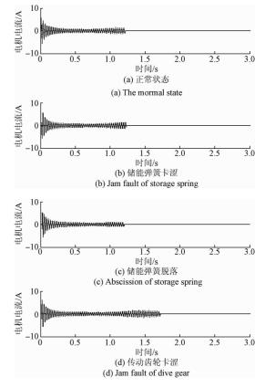
图 3 不同状态的电机电流
