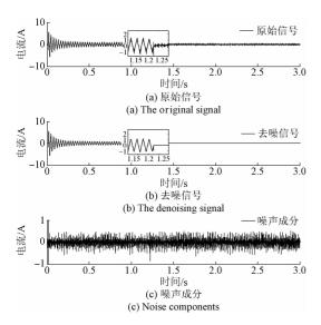
图 2 电机电流去噪效果
