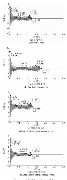
图 6 电流信号包络线的特征点
