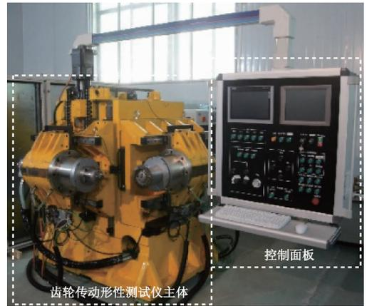
图 12 齿轮传动形性测试仪
