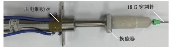
图7 压电式振动穿刺针
