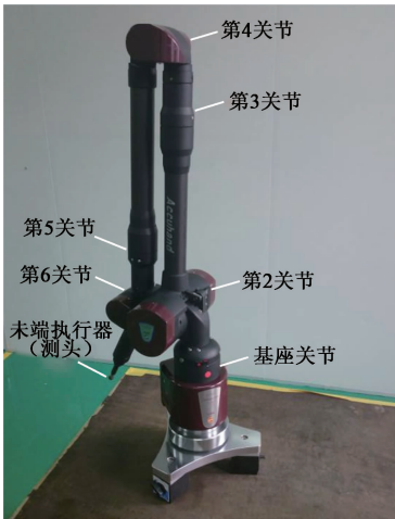
图 5 SINO5 六关节测量系统 Fig. 5 SINO5 measurement system
