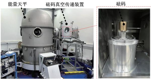
图10 砝码传递过程准确性实验系统
