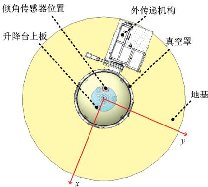
图 12 能量天平激励磁体倾角测量系统
