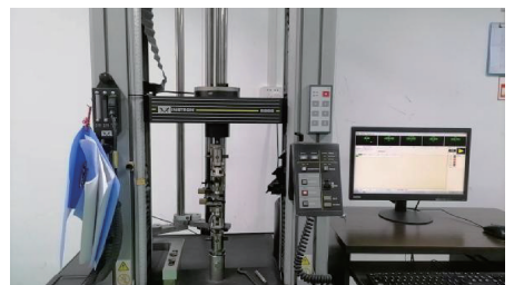
图5 INSTRON-5866 型材料拉伸机
