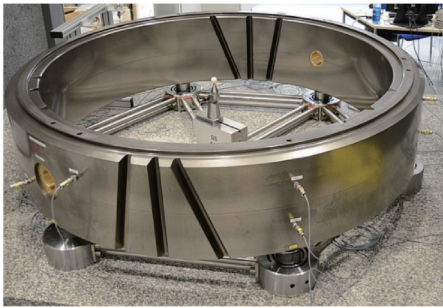
图21 PTB大齿圈样板
