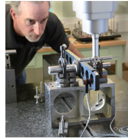
图35 NIST 齿轮样板测量
