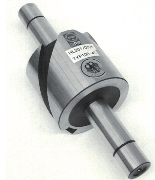
图 40 45^\circ 螺旋线比对样板
