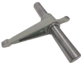
图7 Zeiss 双基圆渐开线样板
