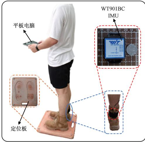
图 4 IMU 数据采集示意图
