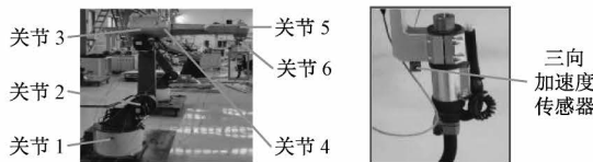
图 5 三向加速度传感器安装位置
