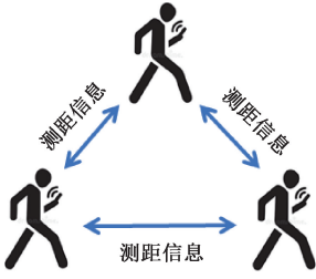
图2 测距信息辅助协同导航示意图
