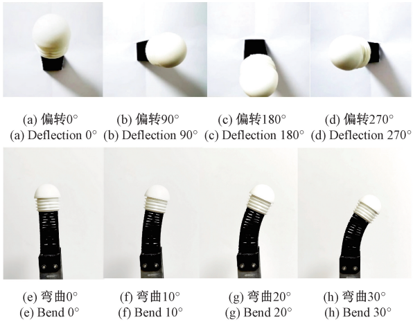
图 30 柔性连续体弯曲单元运动实验
