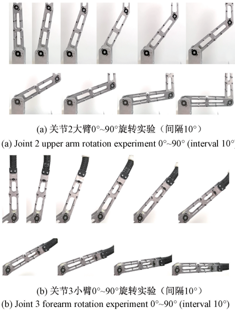
图 28 关节 2 和 3 的运动控制实验
