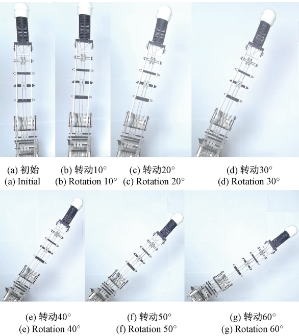
图 26 角度定位实验
