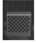
图 8 激光平面标定图像
