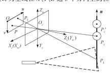
图 2 三维垂线测量原理图
