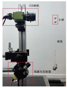
图 6 测量装置结构图
