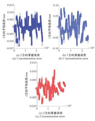
图 10 激光平面特征点的重建误差图
