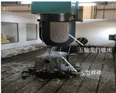
图11 S型样件加工现场
