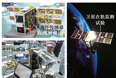
图 8 搭载卫星开展光纤监测系统空间飞行验证试验 [46]
