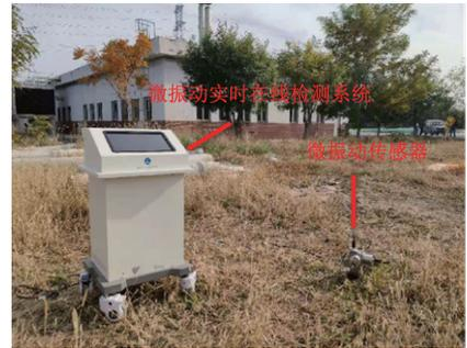
图 6 微振动实时在线检测系统
