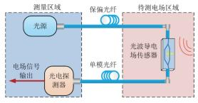
图 1 集成光波导电场传感系统组成
