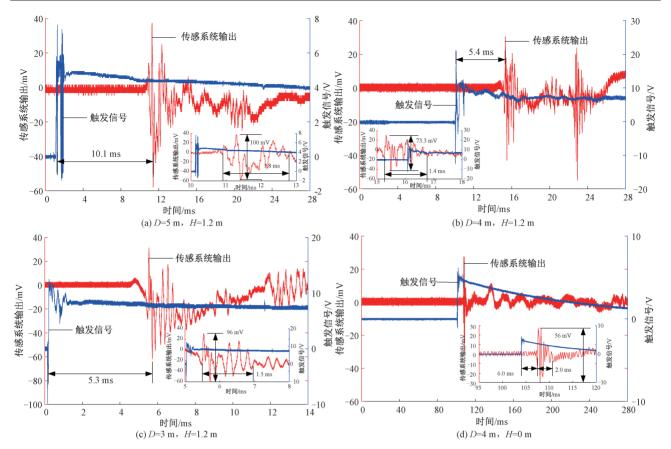
图 10 爆炸辐射 EMP 时域波形测量结果
