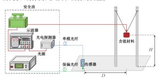
图 9 爆炸辐射 EMP 测量系统
