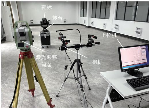
图4 激光跟踪姿态测量系统实验验证装置
