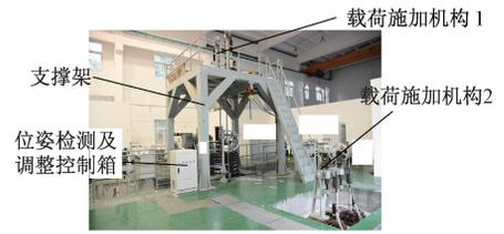
图6 校准装置
