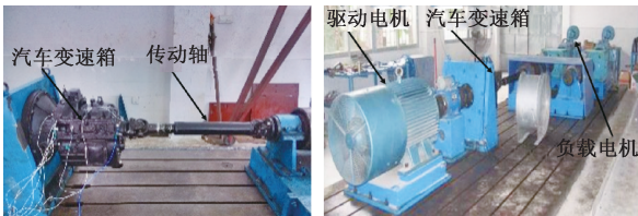
图 3 旋转机械试验平台 Fig. 3 Rotating machinery experiment platform
