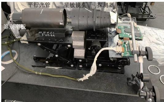
图 17 星敏传感器星点检测系统
