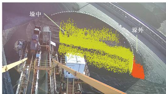
图5 向右回转过程右侧雷达扫描点云
