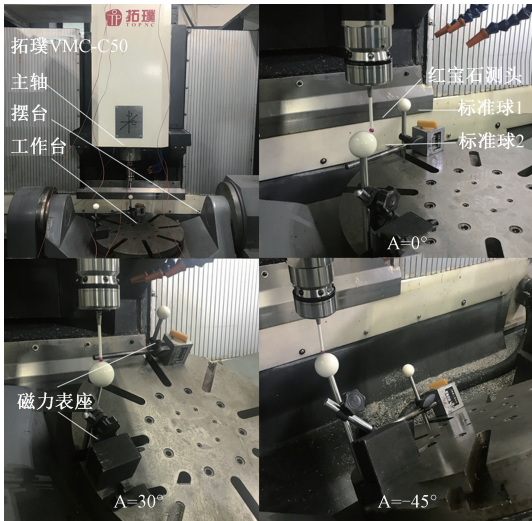
图 6 在机测量标准球球面坐标实验 Fig. 6 On-machine measurement of standard spherical coordinates experiment
