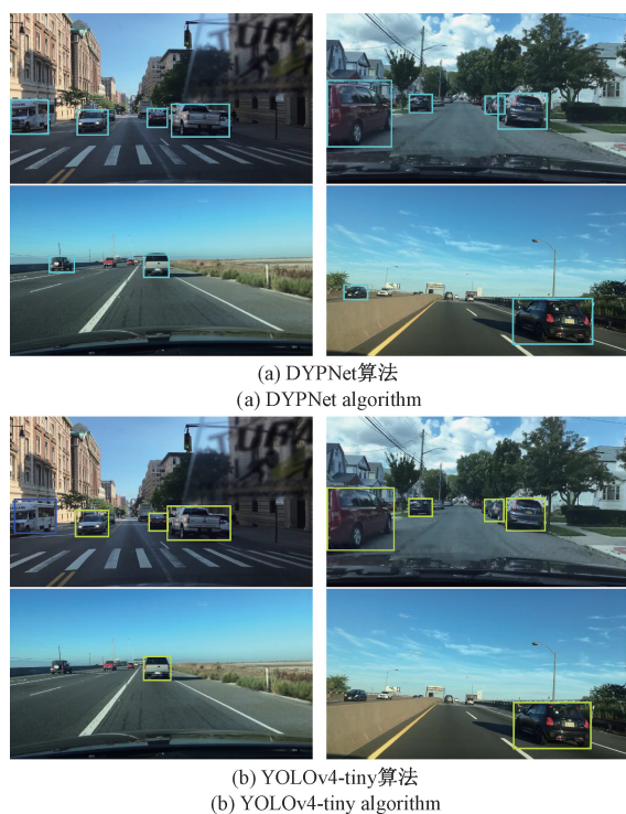
图 7 在 BDD100 K 数据集上的检测对比 Fig. 7 Detection comparison on BDD100 K dataset
