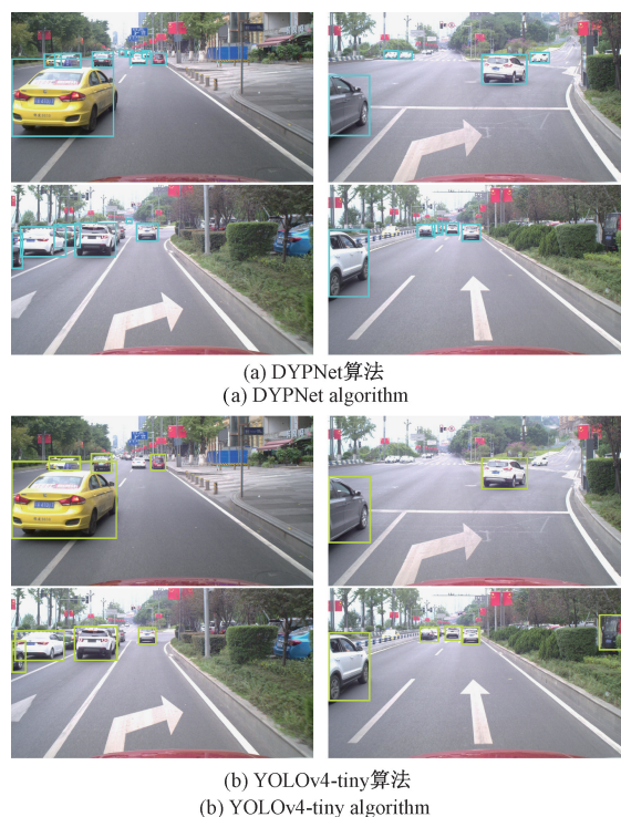
图 8 在自采数据集上的检测对比 Fig. 8 Detection comparison on self-collected dataset
