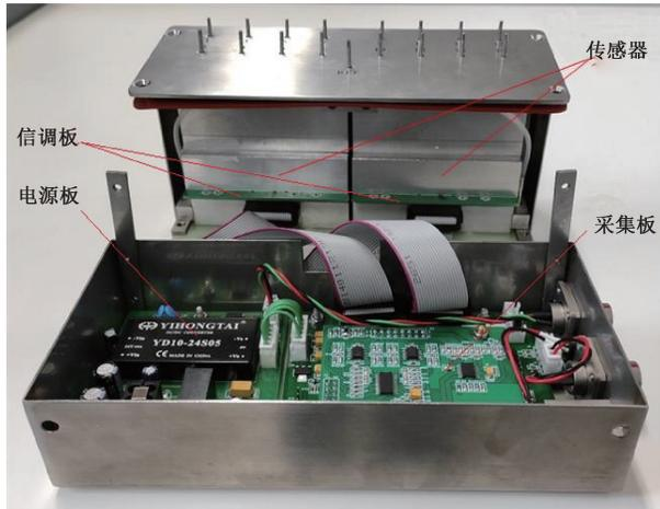
图5 压力采集系统实物
