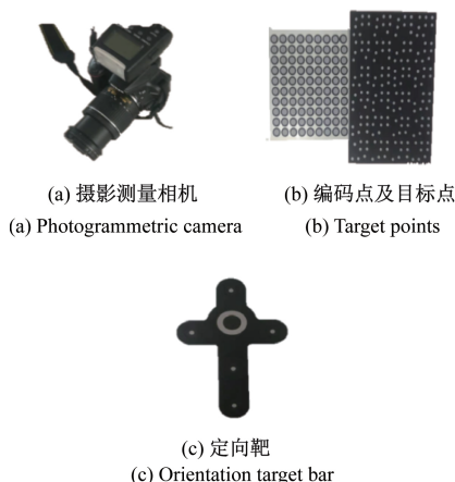
图 5 摄影测量系统硬件组成
