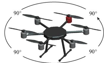
图10 六旋翼无人机标定过程中转动节拍
