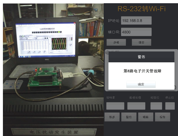
图8 基于电压扰动发生装置测试结果
