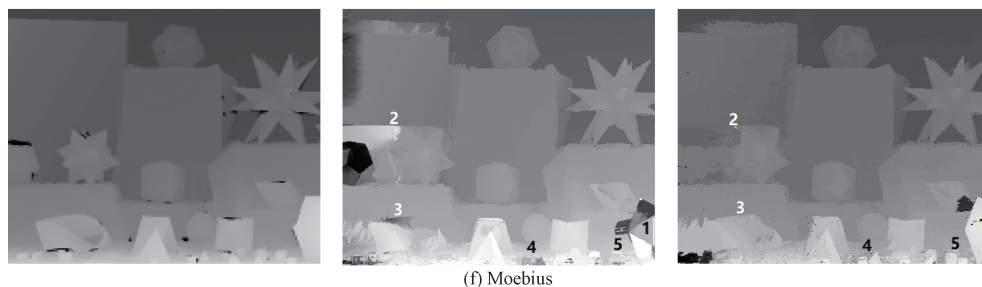
图 10 真实视差图像、PMS 算法与本文的改进算法的视差计算效果比较
