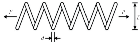
图 3 压力弹簧模型
