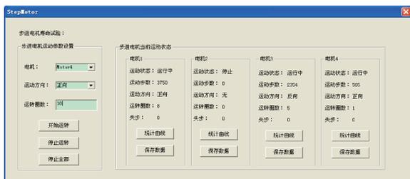
图 7 步进电机寿命试验软件的使用界面
