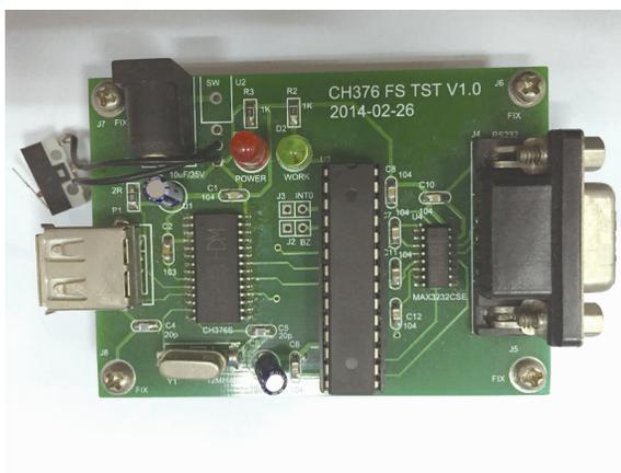
图 5 基于单片机的 USB 文件读写方案电路板
