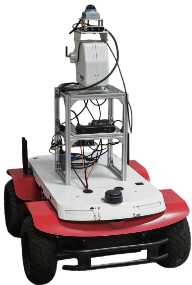
图 5 变电站智能巡检机器人平台
