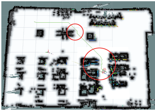
图 13 原始 A* 和 DWA 算法实车导航结果 Fig. 13 Navigation results of the original A* and DWA algorithms on a real vehicle
