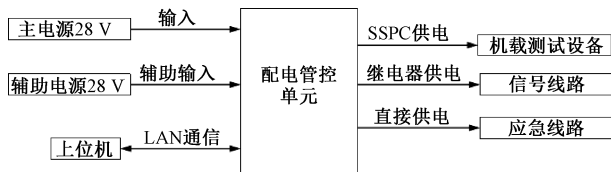
图 1 配电管控单元总体方案设计
