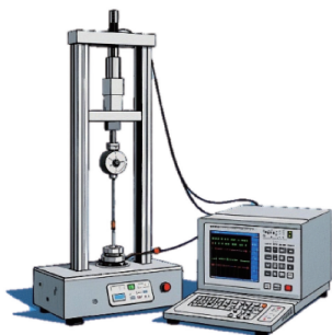
图 3 传感器拉伸测试
