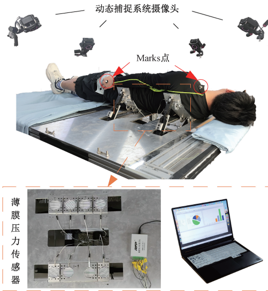
图4 人体侧翻角度及压力数据采集试验台
